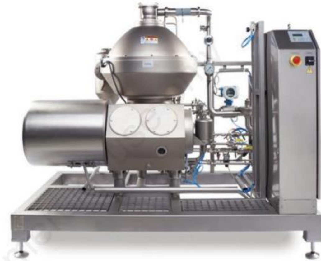
fig. 1.2b Alfa Lavela Hermetic Disk Bowl Centrifuge
